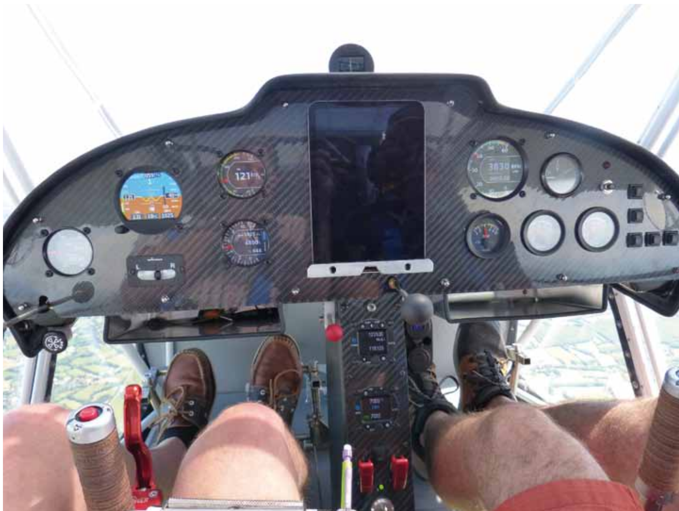
Instruments de vol à gauche, indicateurs moteur à droite, radio, transpondeur et allumages/démarrreur sur la console centrale : tout tombe bien sous les yeux et sous la main.
