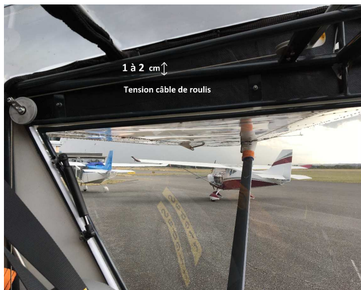
Tension câble de roulis (1)
