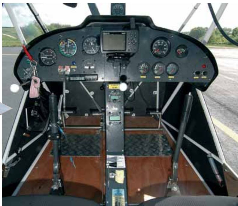
> L'instrumentation complète mais classique est bien répartie : cadrans de vol à gauche et moteur à droite.
