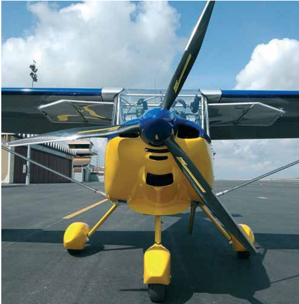
> Vue de face l'hélice « Duc Swirl Inconel » ajoutée aux bonnes performances du SG 10 A.
