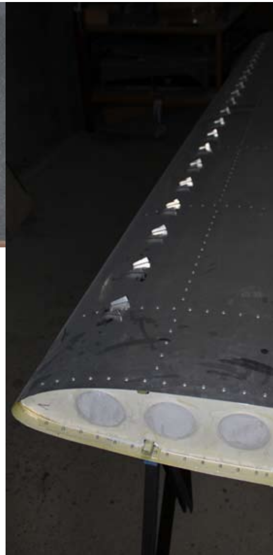
Détail des VG (vortex generators), qui permettent de substantiels gains aux basses vitesses
